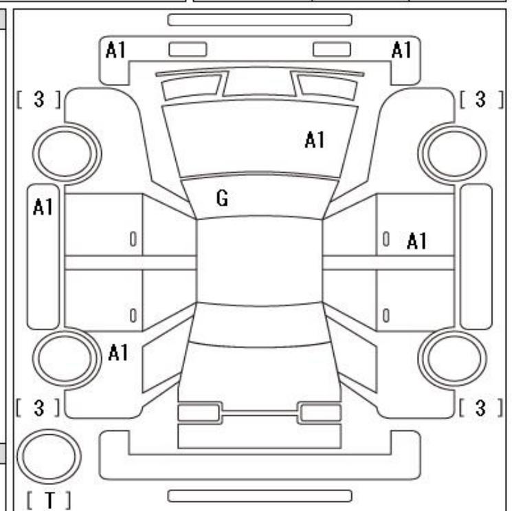
A:軽 U:43 B:軽を伴う43 P:要塗装 W:補修跡 S:錆 C:腐食 G:70外が52点軽 XX:交換済み X:要交換 内・外装評価 5段階5段階順(A・B・C・D・E) 4
